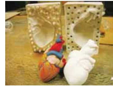
シリコンの型 ( 後方 ) に石膏を流し込み 原型が完成 ( 右 )
