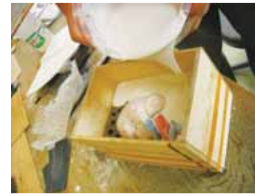
原型を粘土で固定、 シリコンゴムを流し込んで型取り
