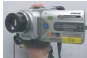
マクロレンズをDVカメラに取り付けた図
