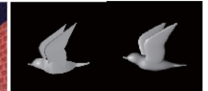
▲ HyperNURBS (ハイパーナーバス) 左がポリゴンでおおまかな形状をモデリングしたもの 右が左を基にHyperNURBSを使ったもの HyperNURBSを使うと基の形状が細分化され複雑な形状でもなめらかに作ることができる。
