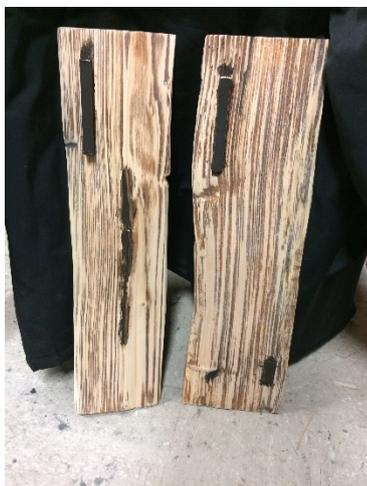
丸太のときは、木が完全に乾いていなかったため簡単に割ることができた。次の 50mm の板は、乾いていたのもあり、綺麗に半分に割れなかった。節が多く表面が凸凹していた。固めの作業で表面のバリや尖った部分を除去した。裏面を滑らかにするのが苦労した。木地に色漆と木地呂漆を塗って仕上げる。
