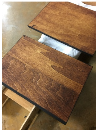
固め・錆付け(小口)
