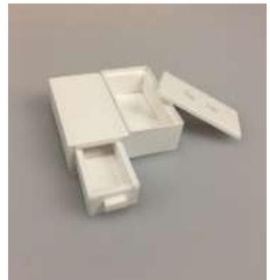
衣服の収納に使用することを考えて制作した。収納できる部分の高さは、既製品の調査と訪問調査で衣服を収納している家具を測り、220mmに設定した。幅は衣服をたたんだ際に入る幅、強度を考え、できるだけ多くのボックスを並べるために310mmに設定した。奥行きは460mmである。壁側のほうは引き出すことができないため、上のボードを取り外せるようにし、使わない衣服を収納できるようにした。収納できる部分の高さは225mm、幅は336mm、奥行きは464mmである。
