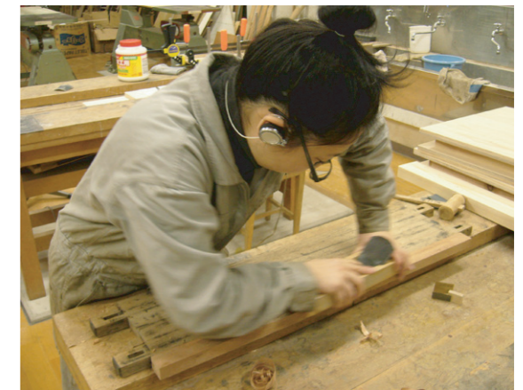
接ぎ木した部材の成型(鉋がけ)
